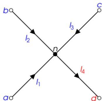
Le débit total d'électrons entrant dans le nœud est identique à celui sortant du nœud.
