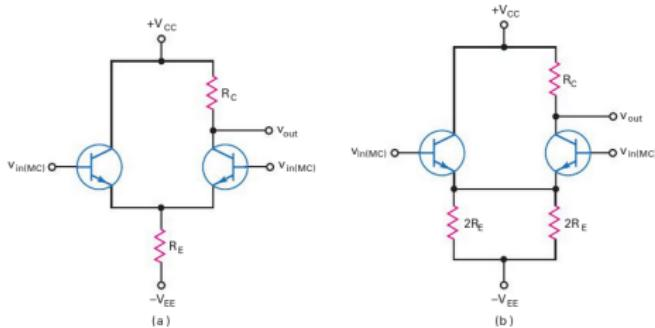
Signal d'entrée en MC et circuit équivalent (d'après A. Malvino).
