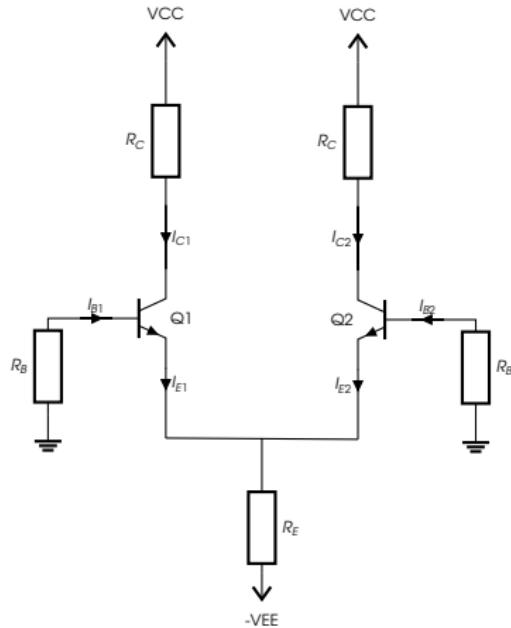
Polarisation de l'amplificateur différentiel.
