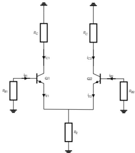
D'après les résultats de la physique du solide, le courant de collecteur peut s'écrire  $i_C = I_S e^{(v_{be}/v_T)}$ , avec :
