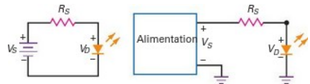
Figure 2. Circuit fondamental de polarisation d'une LED (d'après MALVINO).
